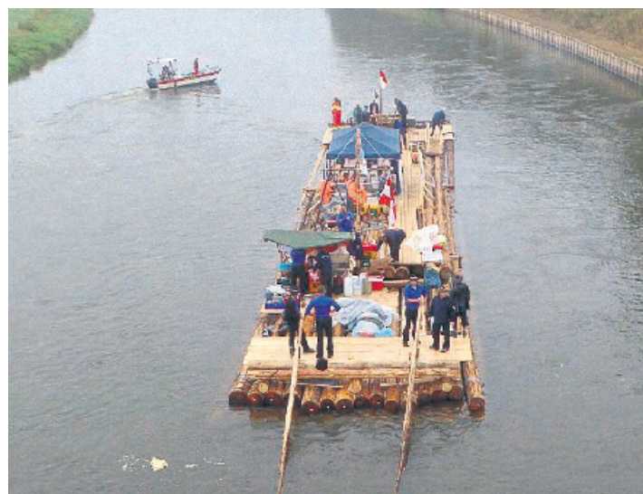
Mit diesem etwa 100 Tonnen schweren und 40 Meter langen Floß ging 2016 die Reise bis nach Minden in Nordrhein-Westfalen. Da das Floß auf einer Bundeswasserstraße unterwegs war, erfolgte zuvor eine Abnahme durch einen Schifffahrtssachverständigen.
