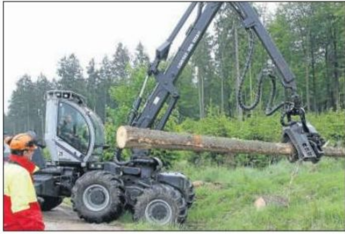
Schweres Gerät: Bei der Fäll-Aktion wurde unter anderem auch ein Harvester eingesetzt.
